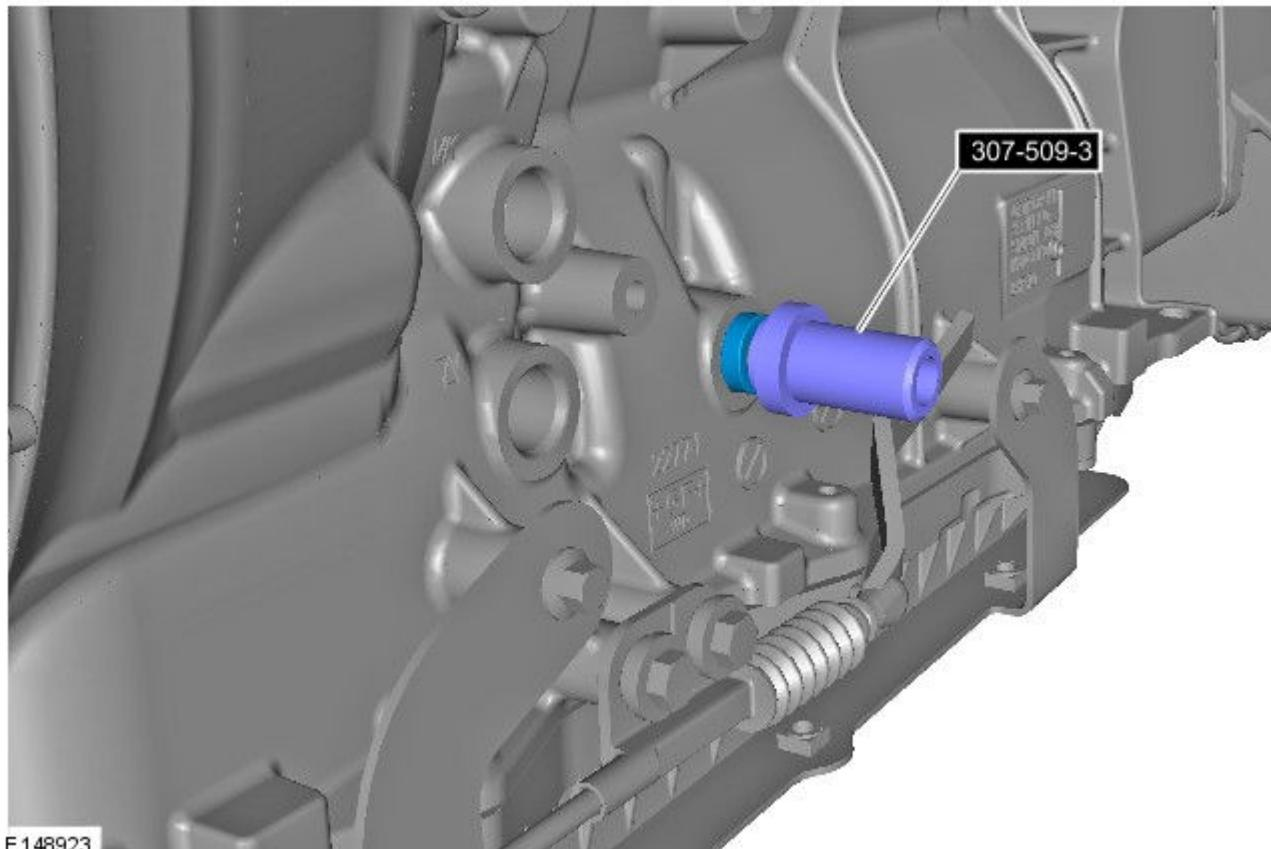
2. 安装变速杆拉索和变速杆。
